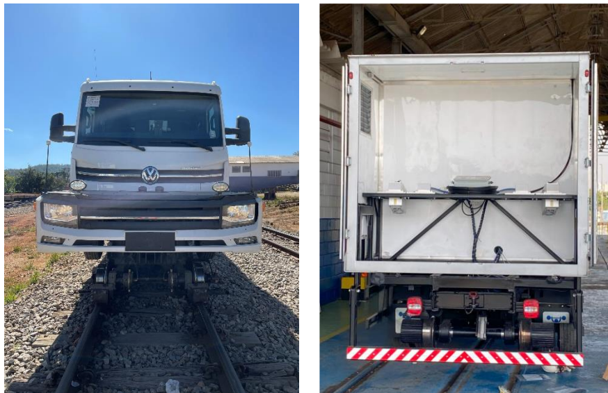
Figura 1. Instalação do LRAIL em veículo rodoferroviário híbrido para a VLI Logística.
