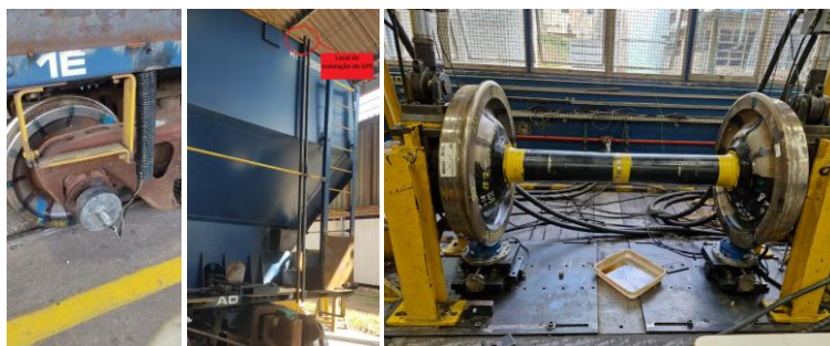
Figura 13. Instrumentação do rodeiro instrumentado utilizado na campanha de campo. Fonte: Autores, 2026.
