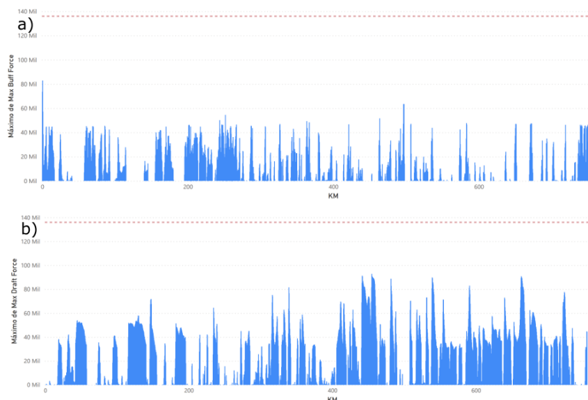
Figura 4. a) Esforços de compressão a 70 km/h. b) Esforços de tração a 70 km/h. Fonte: Autores (2026).
