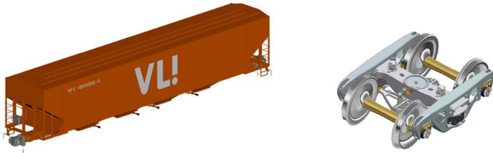
Figura 9. Modelo do vagão HFE: caixa, truque, sistema de amortecimento e rodas.
