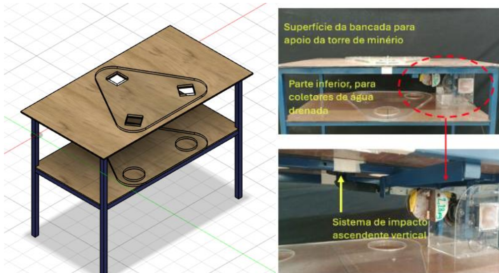
Figura 1. Desenho esquemático em CAD da Mesa de Vibração (à esquerda); Detalhes do mecanismo de impacto (à direita). (Adaptado de Florence, 2024)
