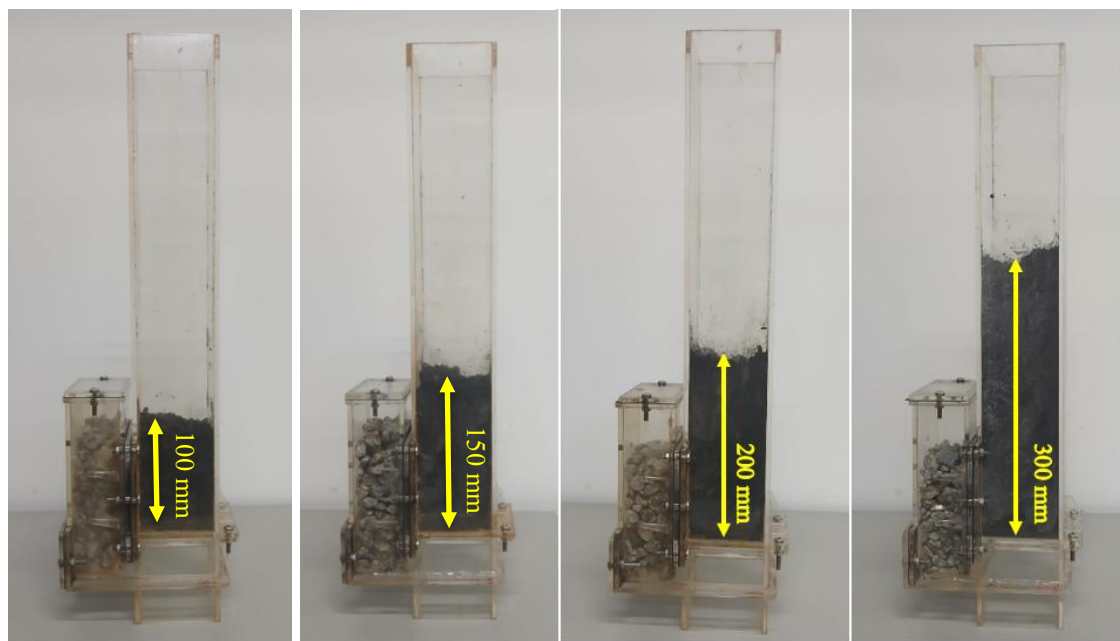
Figura 4. Torres com as quatro diferentes alturas de coluna inicial de pellet feed antes dos ensaios.
