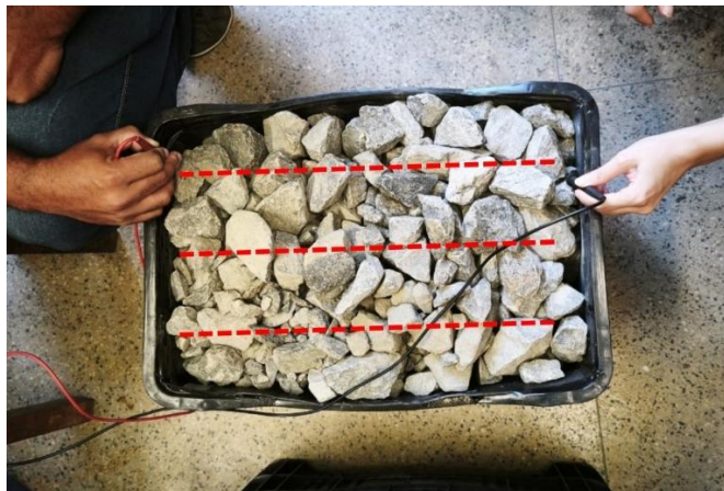
Figura 1. Medição da resistência elétrica do material. Fonte: Autores (2026)
