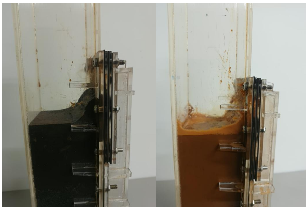
Figura 12 - Minério acumulado na região próxima ao dreno lateral superior, diminuindo o fluxo de drenagem
