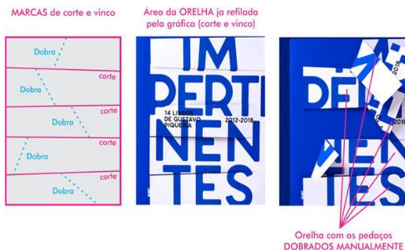
Figura 2 – Esquema da etapa industrial de corte/vinco e da etapa de dobragem manual. Imagens do site Casa Rex. Disponível em: < http://casarex.com/narrativas/impertinentes-2/ >. Elaborado pelo autor.
