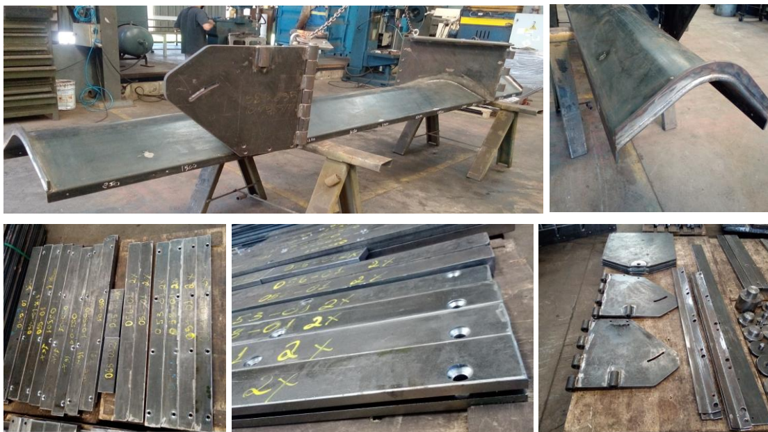
Figura 10. Peças em confecções do arado e chapas de desgastes novas para testes. Esse novo arado aplicado na reguladora R-13.
