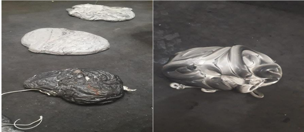
Figura 04 – Borrás purgadas na troca de cor saindo do preto para o branco.
