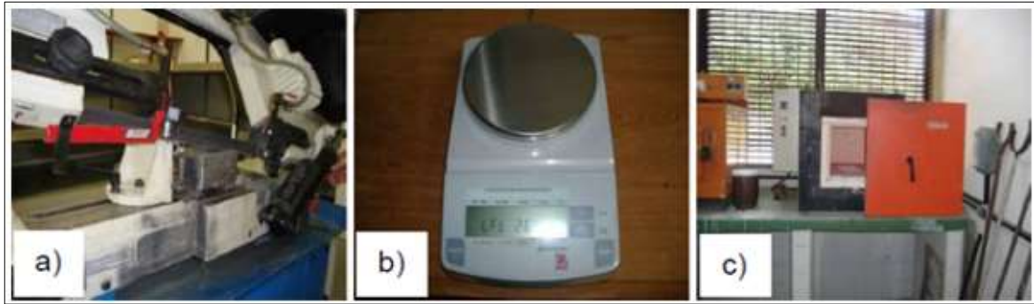
Figura 2 – Equipamentos utilizados: (a) serra fita, (b) balança de precisão e (c) forno mufla
