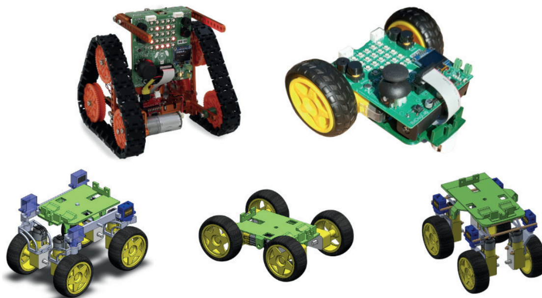
Figura 4: Modelos de robôs educacionais desenvolvidos com a BitDogLab, apresentando cinco variações estruturais voltadas a diferentes contextos e objetivos pedagógicos.
