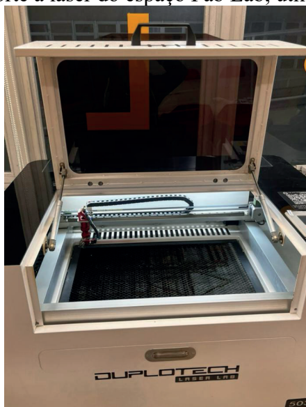
FIGURA 2: Máquina de corte a laser do espaço Fab Lab, utilizada para produção do jogo
