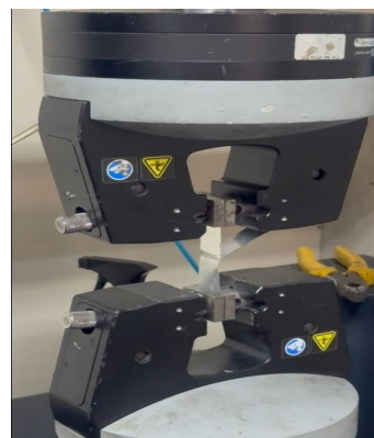
Figura 2: Ensaio mecânico pelo método peel-test
