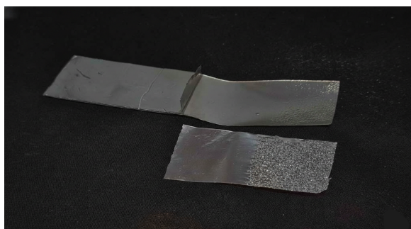
Figura 9: Corpo de prova rompido durante peel test
