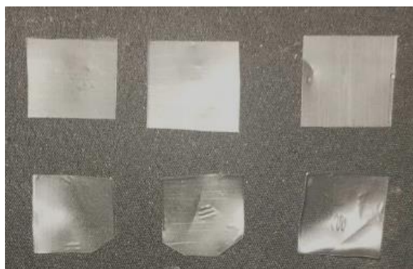
Figura 9. Comparação entre a amostra da semana 0 (superior) e de 10 semanas de alta umidade (inferior).
