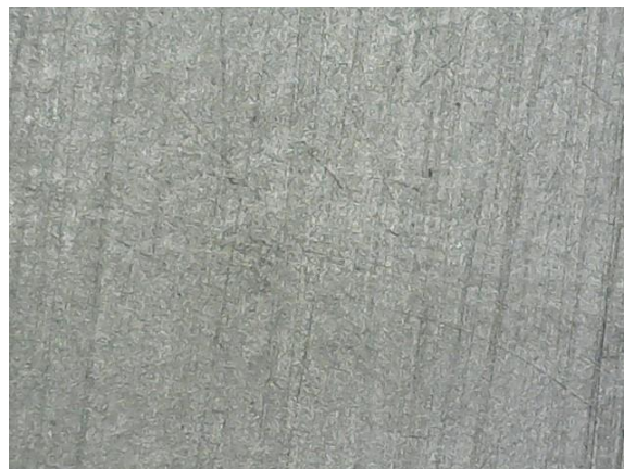
Figura 12. Imagem da superfície da amostra em tempo de 15 semanas em alta umidade (aumento em 1000 vezes).
