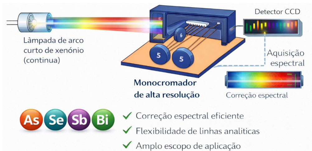
Figura 6- Representação esquemática de um espectrômetro de absorção atômica de alta resolução com fonte contínua (HR-CS AAS).
