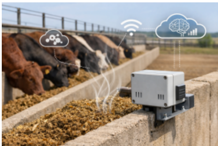
Figura 1 - Representação conceitual do sistema de nariz eletrônico (e-Nose) instalado próximo ao cocho de alimentação em ambiente de confinamento bovino, realizando a detecção de compostos orgânicos voláteis (VOCs) emitidos pela silagem e o envio dos dados para processamento por técnicas de Inteligência Artificial, com o objetivo de monitorar a deterioração aeróbica do alimento.
