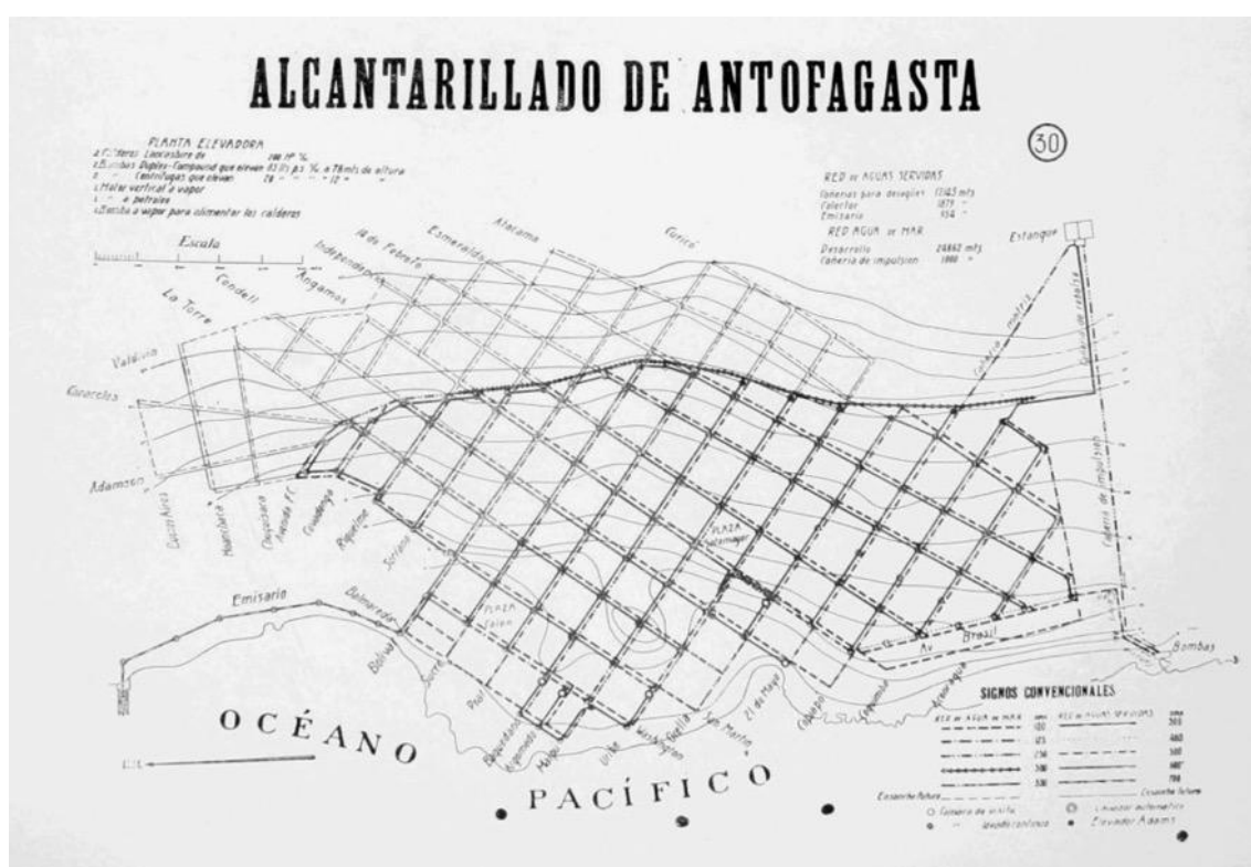
Figura 02: “Alcantarillado de Antofagasta”. Fuente: Publicado en Ferrer, 1911.
