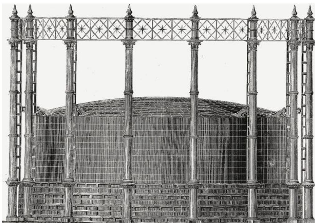
Figura 13. Estrutura do gasômetro, envolto por colunas altas de ferro ornamentadas, conforme projeto do engenheiro John B. Paddon. Fonte: “Gasholder at the Southampton Gasworks”. In: ENGINEERING: an Illustrated Weekly Journal . London: Office for Advertisements and Publication. 04.12.1868. Vol. 6, p.496.
