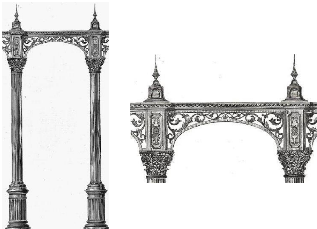
Figuras 14 e 15. Detalhe de um par de colunas encimado por capiteis coríntios, com destaque para o arco ricamente ornamentado em ferro do gasômetro nº 5, em Fulham, a oeste de Londres. Projeto e execução de Thomas N. Kirkham. Fonte: “Guide Frame Columns of Gasholder at Fulham”. In: ENGINEERING: an Illustrated Weekly Journal . London: Office for Advertisements and Publication. 24.04.1868. Vol. 5, p.397.
