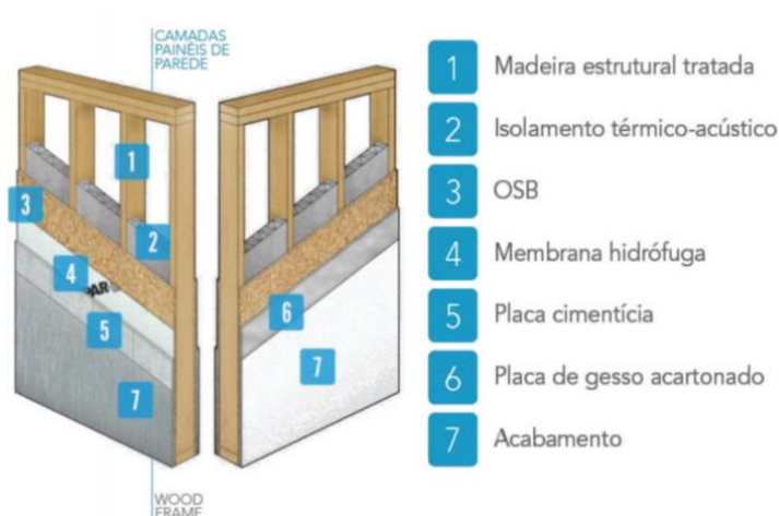
Figura 2: Esquema de um painel multicamadas no sistema wood frame . Fonte: Tecverde (2016, p. 181).
