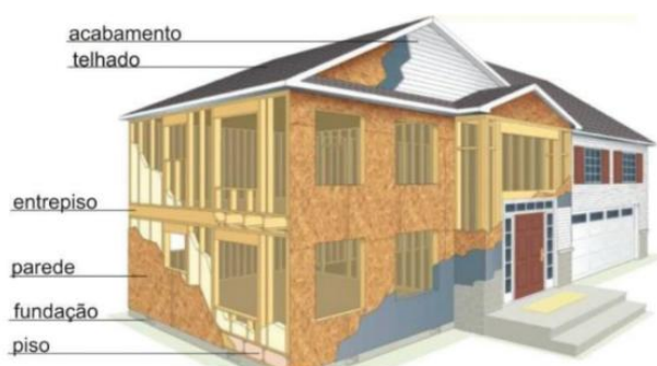
Figura 1: Edificação construída no Sistema Plataforma. Fonte: Tecverde (2016, p. 177).
