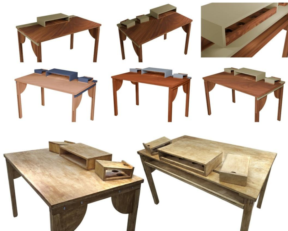
Figura 6: Proposta final com o estudo 3D, definições de cores e tons de madeiras e protótipo confeccionado em madeira do tipo Pinus e compensados ecológicos. Fonte: Os autores (2026).
