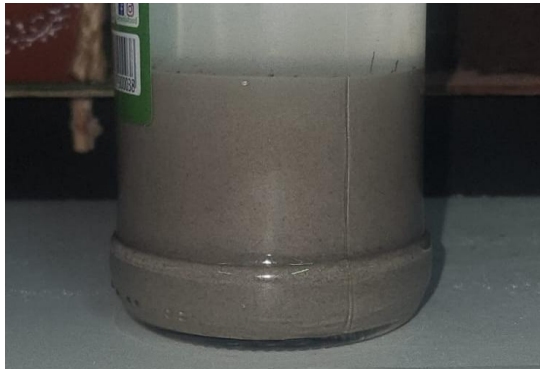
Figura 4: Teste do vidro; identifica a proporção dos componentes da terra. Fonte: Os autores (2025).
