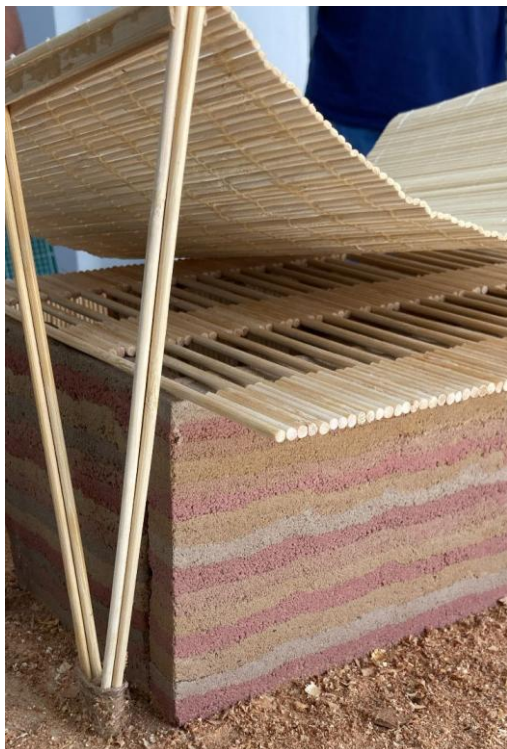
Figura 7: Casa Balaio, em técnica de taipa de pilão. Fonte: Dias (2025).
