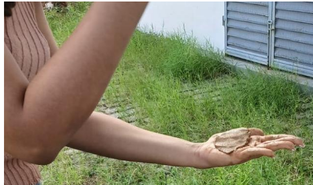
Figura 5: Teste de exsudação; identifica a absorção de água pela terra. Fonte: Os autores (2025).
