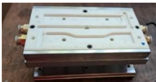
Figura 2 - Ferramental Aditivo Pronto para Montagem no Porta-Molde Metálico. Fonte: Os autores (2026).
