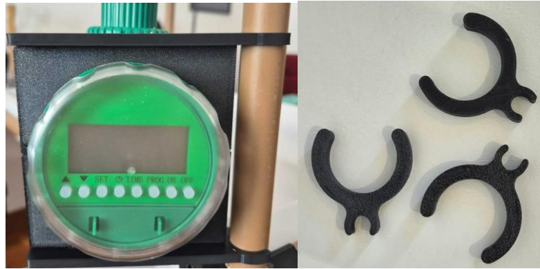
Figura 6: suporte do controlador de irrigação e presilhas para mangueiras. Fonte: Elaboração própria (2025).
