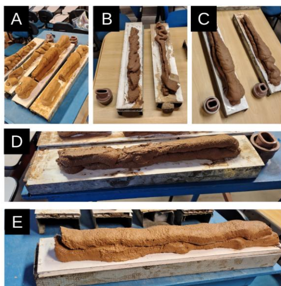
Figura 6. Resultados obtidos com as ponteiros não escolhidas (A, B, C e D), e resultado da ponteira escolhida (E), Fonte: Os autores (2026).
