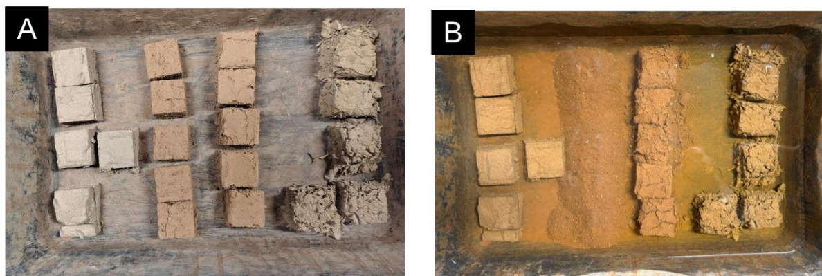
Figura 9. Corpos de prova antes e após submersão em água, Fonte: Os autores (2026).
