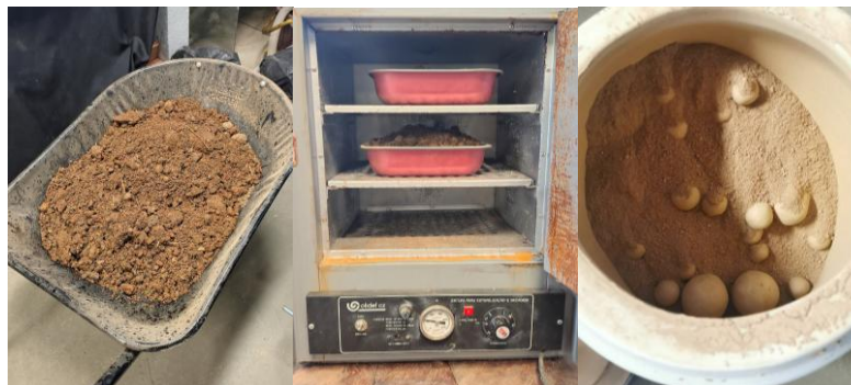
Figura 1. Coleta, secagem, destorroamento e moagem do solo Fonte: Os autores (2025)
