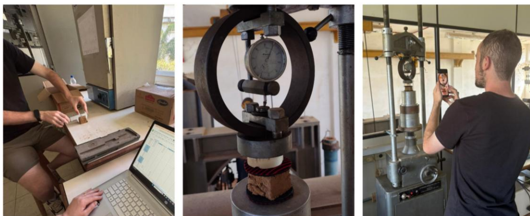
Figura 8. Realização do teste de resistência mecânica, Fonte: Os autores (2026).
