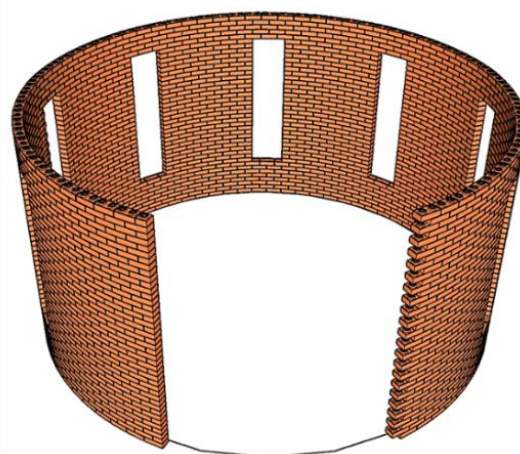
Figura 5 - Composição 1 - BTCs transpassados (convencional) e Composição 2 - BTCs com curvatura de raio interno de 3.00m. Fonte: Os autores (2026).
