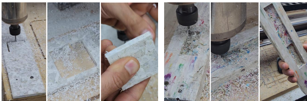
Figura 7: Corte e desbaste das peças de plástico. Fonte: Os autores (2026).
