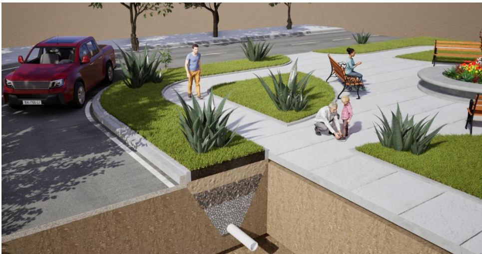
Figura 5: Parcelamento Reserva do Parque, DF – Desenho conceitual de Jardins de Chuva para ELUPS. Fonte: Os autores com base em Distrito Federal (2024) e GEOPORTAL (2023).
