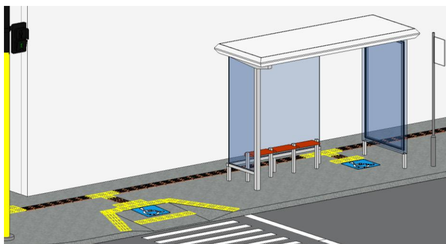
Figura 4: Proposta de abrigo acessível para paradas de ônibus, corte 3D. Fonte: Autores (2025).
