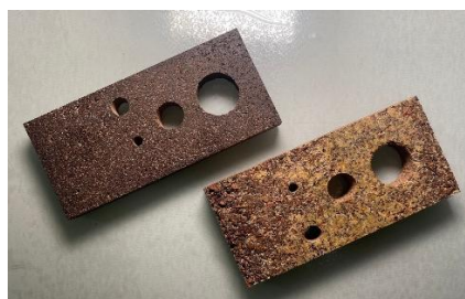
Figura 18: Furos feitos no compósito (placa 1 e 2) com broca passante e broca helicoidal. Fonte: Autores.
