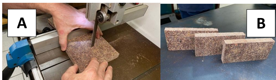
Figura 15: a. Processo de corte da placa piloto em serra de fita; b. Amostras com cortes feitos. Fonte: Autores.
