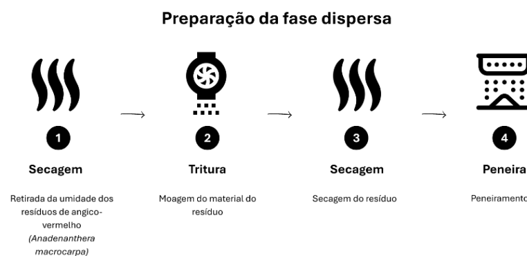
Figura 6: Esquema visual das etapas para a preparação da fase dispersa. Fonte: Autores.
