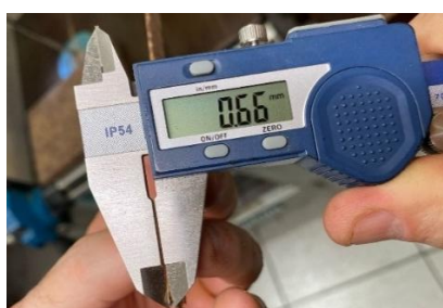
Figura 17: Laminação do compósito a 0.66mm. Fonte: Autores.
