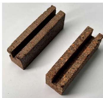
Figura 16: Amostras submetidas ao teste de rasgo. Fonte: Autores.
