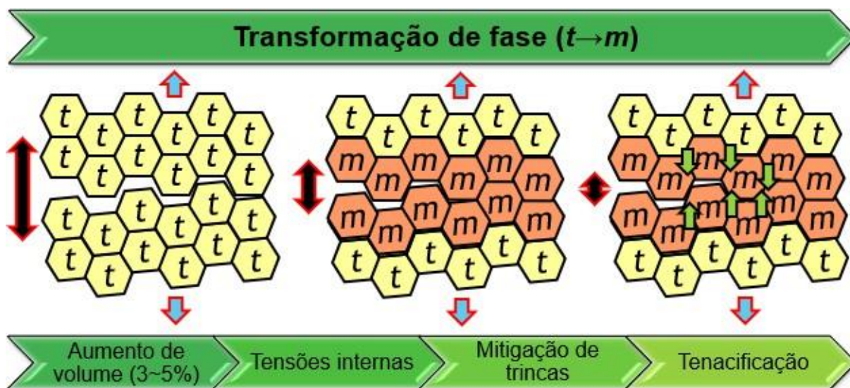
Figura 3 – Representação da transformação de fase de tetragonal para monoclinica.
