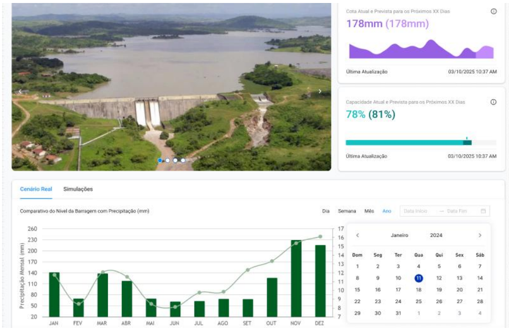
Figura 3 – Painel analítico do AquaVision para monitoramento do nível da barragem, precipitação associada e previsão operacional.
