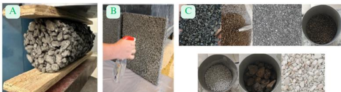
Figura 1: Exemplo de técnicas e materiais utilizado nos estudos. (A) Ensaio compressão diametral de amostras com RCD; (B) Aspersão de nanografeno no concreto e (C) Resíduos de origem industrial e siderúrgica. Fonte: Huang e Wang, 2024; Barišić et al. (2025); Teymouri et al. (2020)
