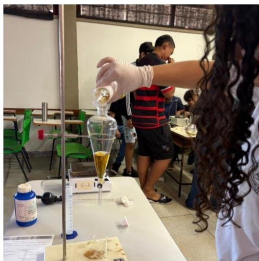
Figura 6. Etapa de decantação no funil de separação.
