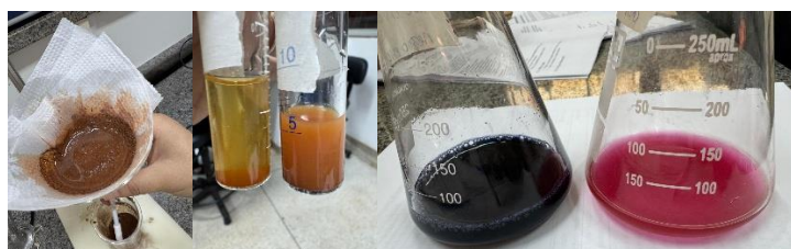
Figura 1. Sequência analítica realizada pelo PET: extração, reações de identificação e teste de pH.
