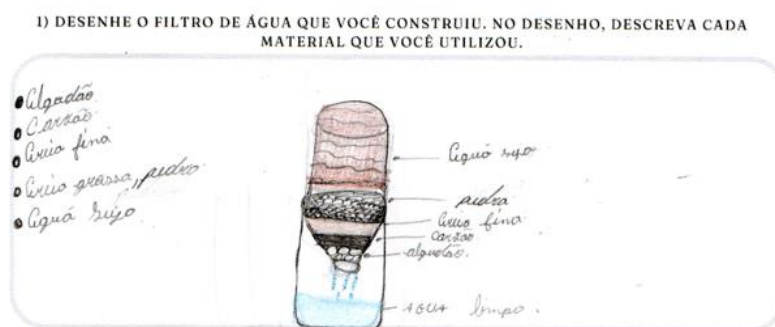
Figura 3. Representação do filtro construído em sala de aula, conforme desenho produzido pelos estudantes.
