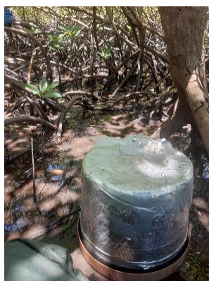
Figura 2. Instalação das câmaras estáticas no solo do manguezal.
