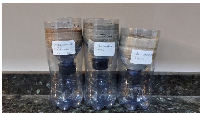
Figura 3. Simulação do filtro do solo feito com argila
