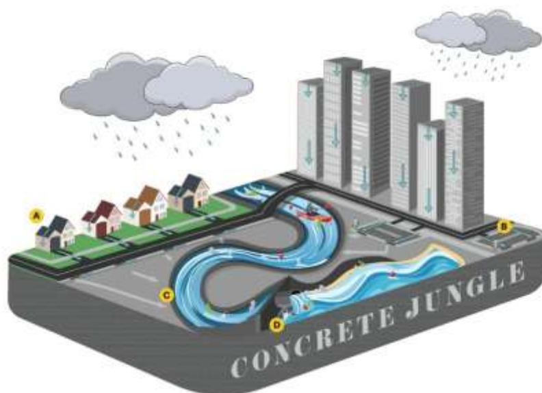
Figura 2: Modelo de cidade com infraestrutura cinza e alta velocidade das águas: A) Tetos impermeáveis; B) Estacionamentos impermeáveis; C) A água da chuva pode sobrecarregar a infraestrutura de drenagem pluvial; D) Resíduos podem ser levados para cursos d'água.
