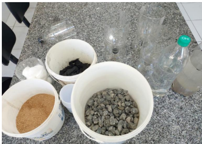
Figura 1. Materiais disponibilizados para a montagem do filtro
