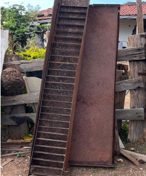
Figura 03 - Fotografia de bica, utilizada para remover os sedimentos mais pesados com uso de água
