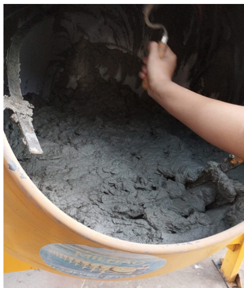
Figura 03 – Aparência do concreto com detergente
