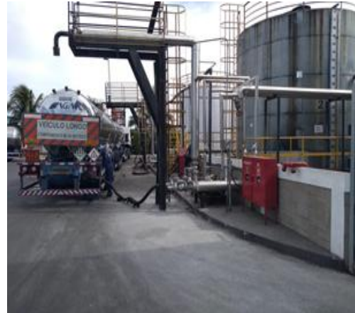
Figura 6 - Chama que eleva temperatura e descarga de ligantes
