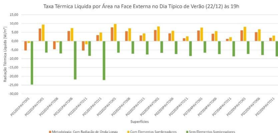
Figura 6: Radiação térmica líquida [W/m²] no dia típico de verão (22/12) às 07h e 19h. Fonte: Autora (2025).
