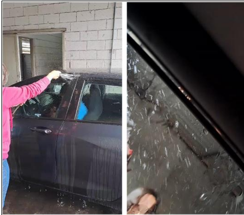
Figura 20: Peça com inserto modificado no veículo em teste de estanqueidade.
