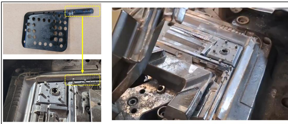
Figura 8: Posicionamento manual do inserto no molde.
