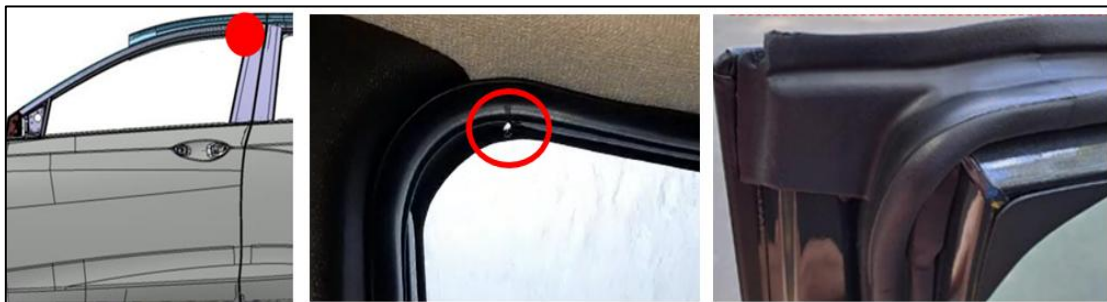
Figura 1: Infiltração de água na parte interna do veículo.
