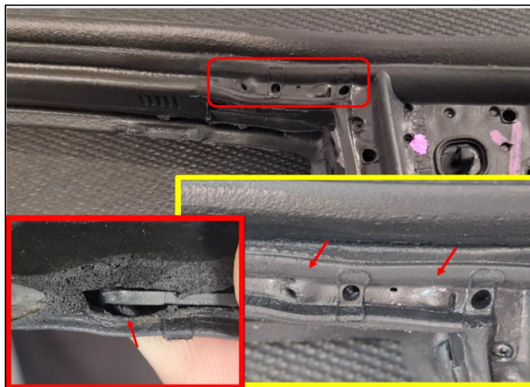
Figura 3: Peça com deformação na extensão do inserto após moldagem.
