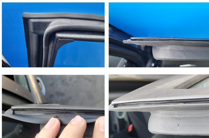
Figura 19: Peça modificada sem extensão do inserto.
