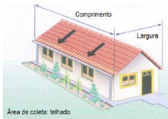
Figura 1 - Área do telhado para coleta
