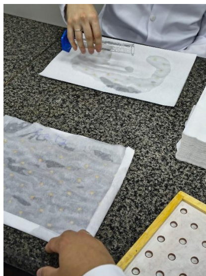
Figura 4 - Imagem da adição da solução de NaCl duas vezes e meio o peso do papel (35 mL)
