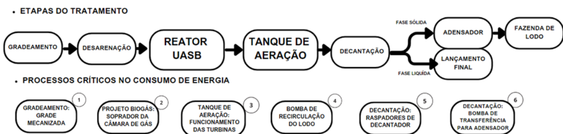
Figura 1: Fluxograma reduzido da ETE Jacuípe II e seus pontos críticos de consumo.
