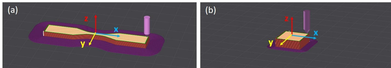
Figura 2 – Representação da orientação de posicionamento dos modelos stl dos CPs para fatiamento e geração de código g-code para impressão. (a) Corpo de prova de tração Tipo V e (b) corpo de prova para avaliação da densidade
