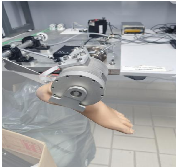
Figura 7 – Teste de bancada para a aplicação do teste em tempo real com a prótese robótica de pé
